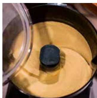
Revolvedores laterales integrados Función cutter, línea COMPACT: caldero equipado con revolvedores laterales para un resultado homogéneo sin necesidad de intervención del operario.
